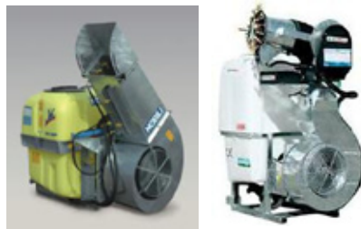
Fig. 19 : Pulvérisateur canon très vulnérable à la dérive
