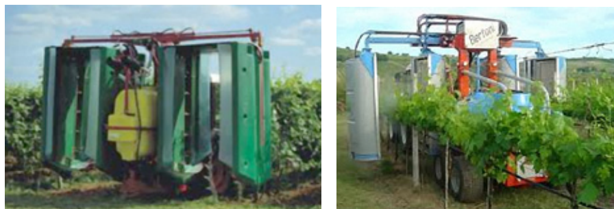
Fig. 23 : Pulvérisateurs équipés de panneaux récupérateurs
