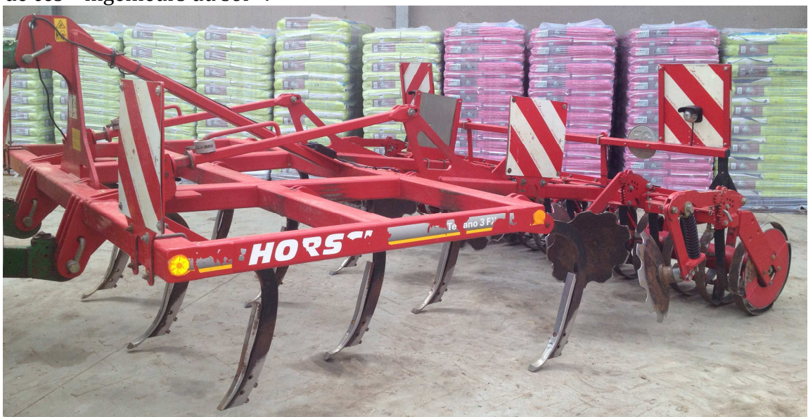
Figure 1 - Chisel Horsch avec les dents "Focus" d'une largeur de 4cm, utilisées en conditions humides. (Photo : D. H.)
