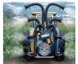
Figuur 8: Spuittoestellen met aanpasbare spuitmonden
